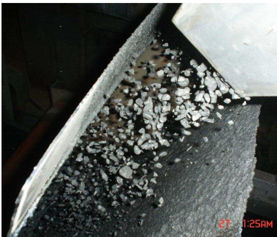
Надрешётный продукт 8-25 мм многочастотного грохота
