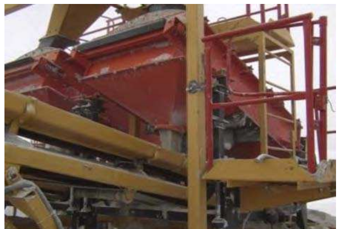
Извлечение мелкого класса 0-5 мм из влажного известняка для получения металлургического известнякового флюса 5-20 мм.
