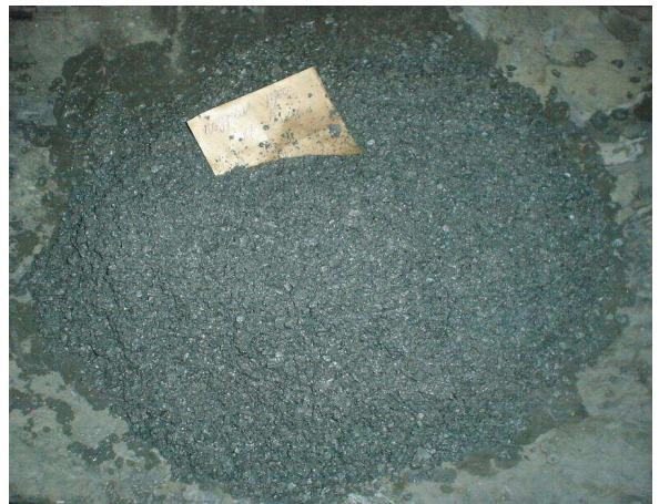
Подрешётный продукт 0-8 мм многочастотного грохота
