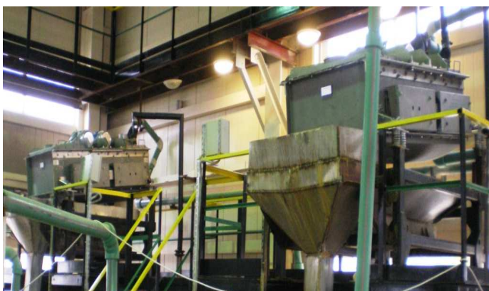
Дешламация и обезвоживание продукта в технологии подземного скважинного выщелачивания урановой руды
